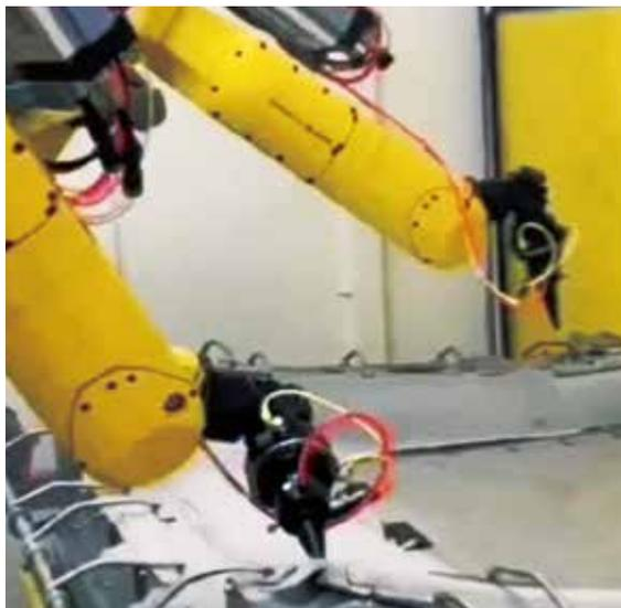
ロボット2台を使用した樹脂切断システム
