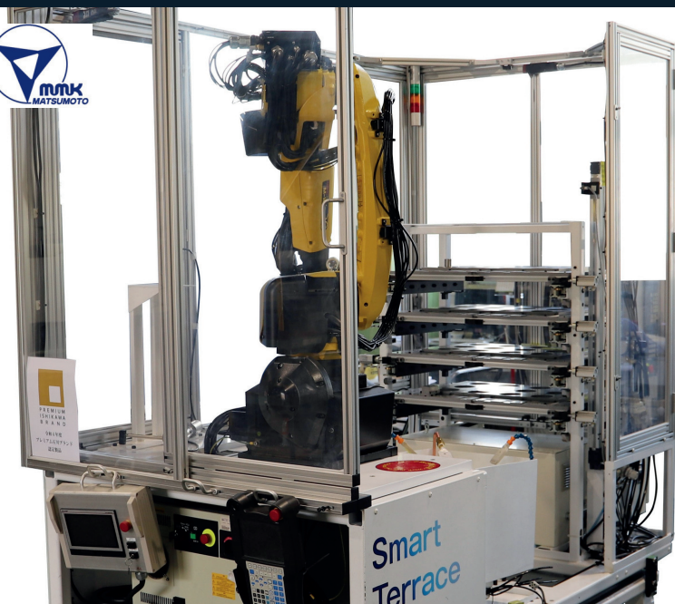
爪もコレットも自動交換、多品種生産に対応 Smart Terrace AIO-M
