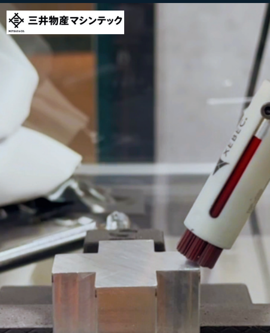
バリ取り自動化 FANUC CRX-5iA + XEBEC ブラシ
